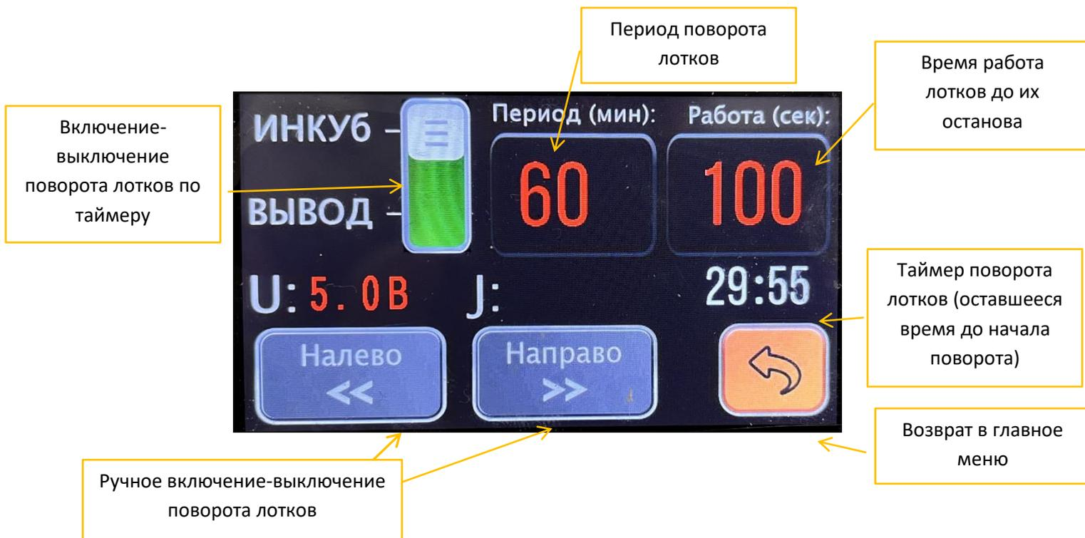
Если включен режим Вывод (по таймеру поворот не работает), то и в ручном режиме нельзя повернуть лотки. Если работает поворот, то индикатор таймер поворота лотков перемещается в заданную сторону по кольцу. Слева от этого таймера показывается нажатый левый концевик, а справа нажатый правый. Если аварии на концевики отключены (в специальном меню), то концевики не показываются.
