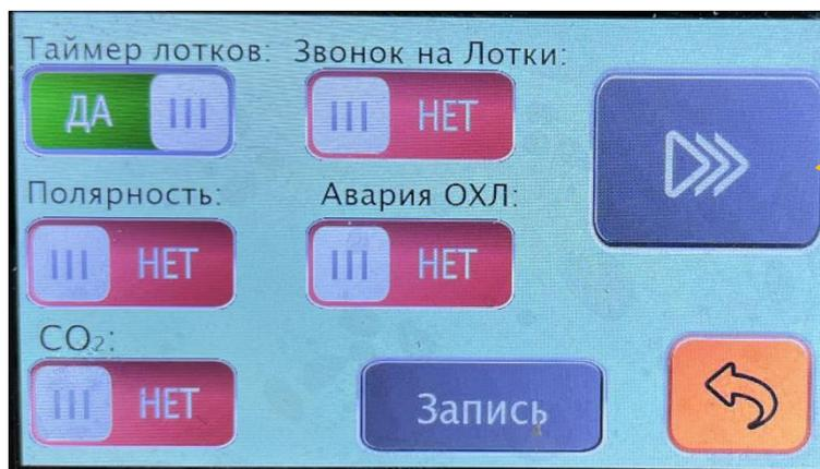
Для изменения параметра нажать на нужный переключатель и для записи в контроллер кнопка **Запись**.
