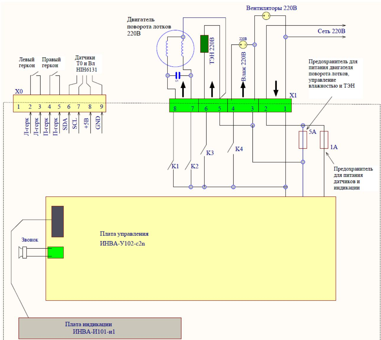
Примечание: В блоке ИНВА-Б102-с1 канала управления влажностью нет.
